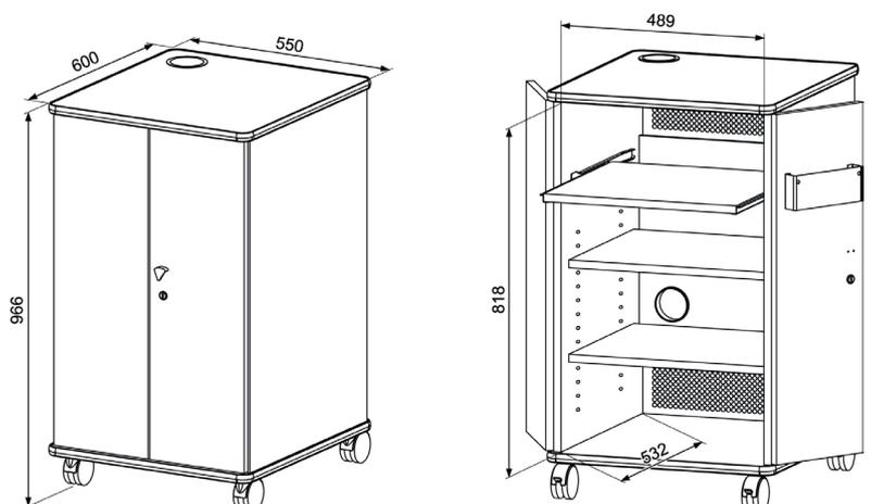
Technische Zeichnung der PW220-Medienwagenmodellreihe (Maßangaben in mm).
